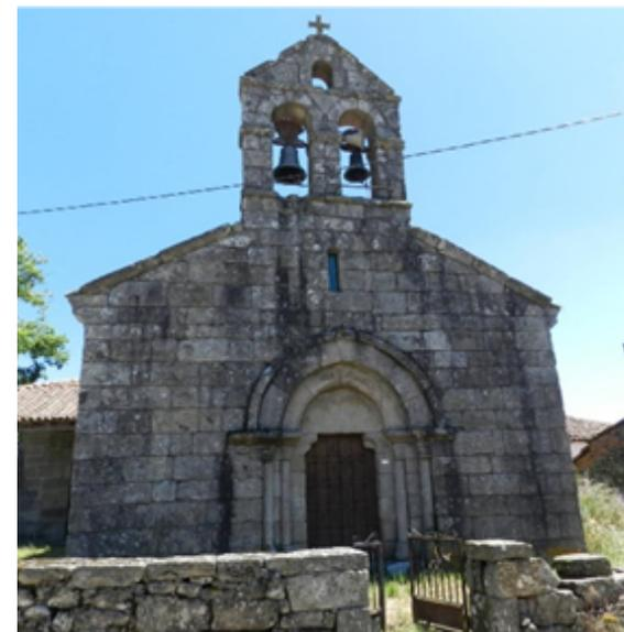
planta de la iglesia al serle agregada la sacristía en el muro norte del presbiterio. Los muros son de mampostería y sillería de granito. La cubierta es de teja a dos aguas. La puerta principal es de arco de medio punto, con dos arquivoltas de sección rectangular con baquetilla en la arista, dos órdenes de columnas acodilladas con capiteles muy esquemáticos, la fachada acaba con una espadaña de dos vanos.
