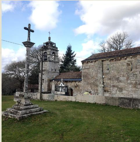
La cubierta es a dos aguas de losa y la teja, y entre ella y los muros se conservan canecillos. Está dividida en varios tramos: Prenave o pórtico, nave y ábside semicircular elevado sobre base pétreo.
